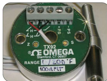
Slika 4. Pojačalo termopara sa dva potenciometra
