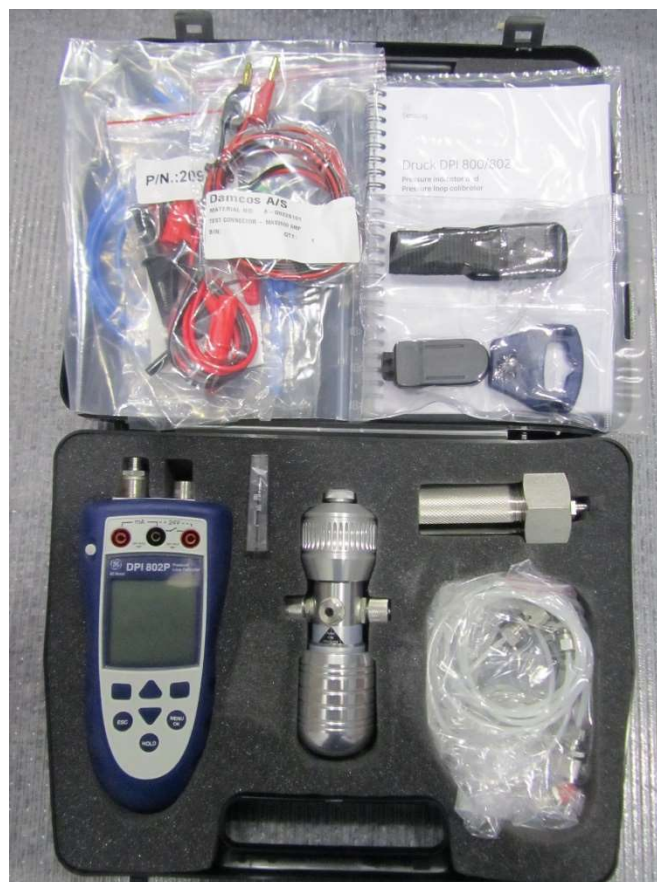
Slika 9. Damacos 2600 test (kalibracijski) kit
