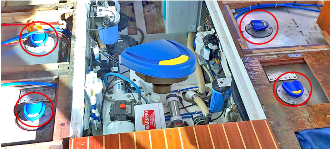
Slika 14. Ultrazvučni senzor goriva
