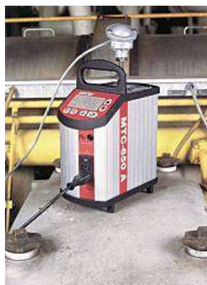
Slika 2. Kalibrator otpornih osjetila
