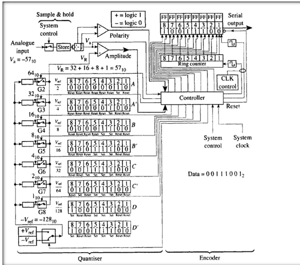
**Slika 9. Enkodiranje signala**
