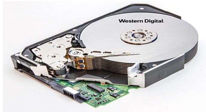
Slika 6. Tvrđi disk sa 9 ploča
