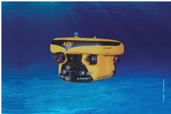
Slika 4. ROV inspekcijske klase
