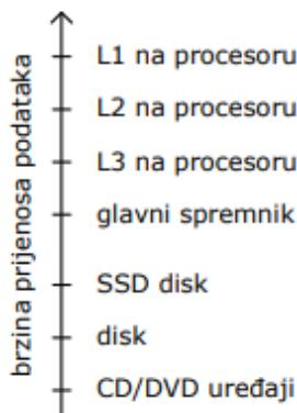
Slika 19: Poredak tipova spremnika prema brzinama prijenosa podataka
