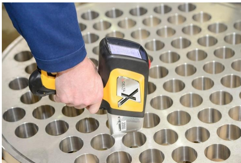
Slika 11. "Pištolj" za određivanje kemijskog sastava slitine
