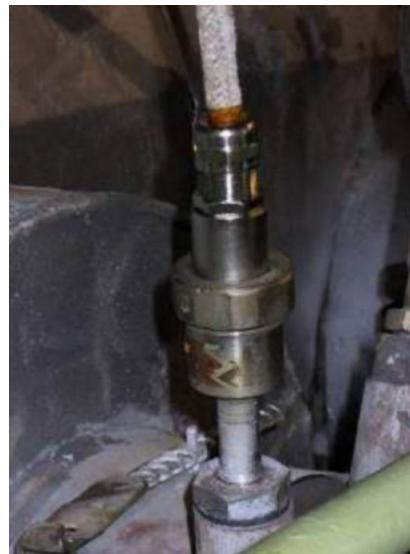
Slika 7 - Prikaz otporničkog termometra na brodskom motoru [6]
