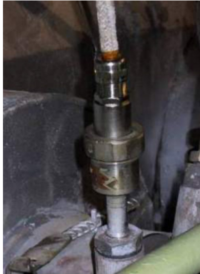
Slika 7 - Prikaz otporničkog termometra na brodskom motoru [6]
