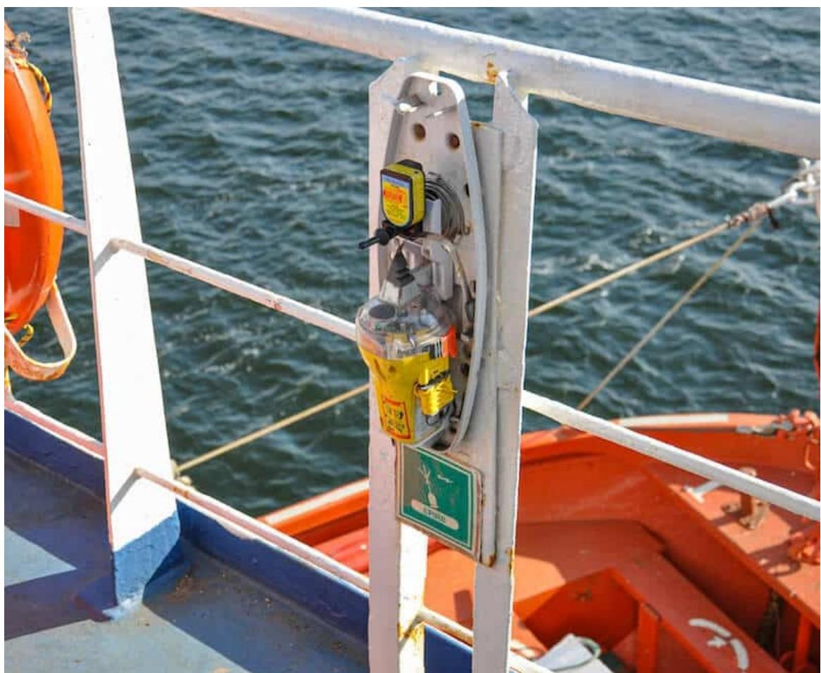
**Slika 10. Prikaz ugrađenog uređaja EPIRB na brodu**
