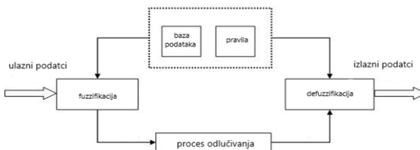
Slika 10. Prikaz mehanizma neizrazitog zaključivanja - FIS [148]
