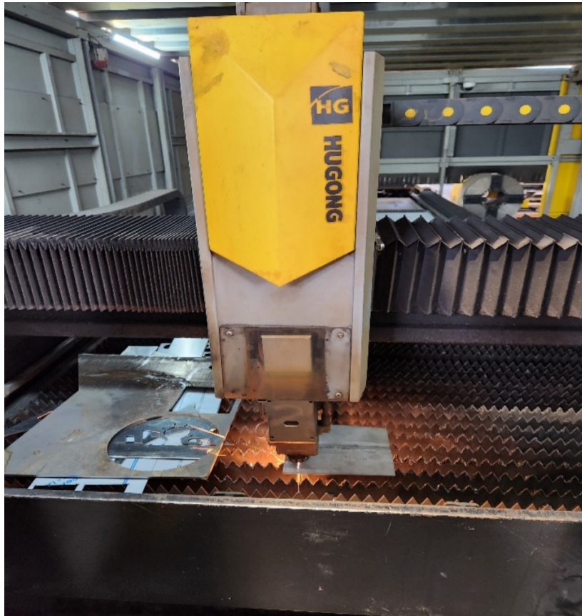
Slika 20. Lasersko izrezivanje uzoraka Izvor: Autor
