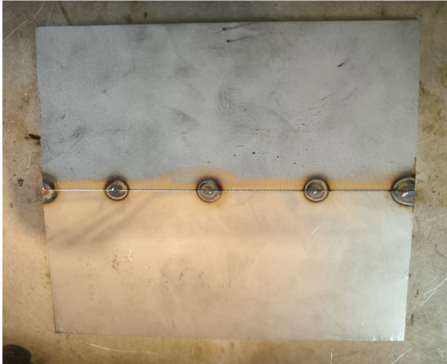
Slika 15. Primjer limova spojenih točkastim zavarom Izvor: Autor
