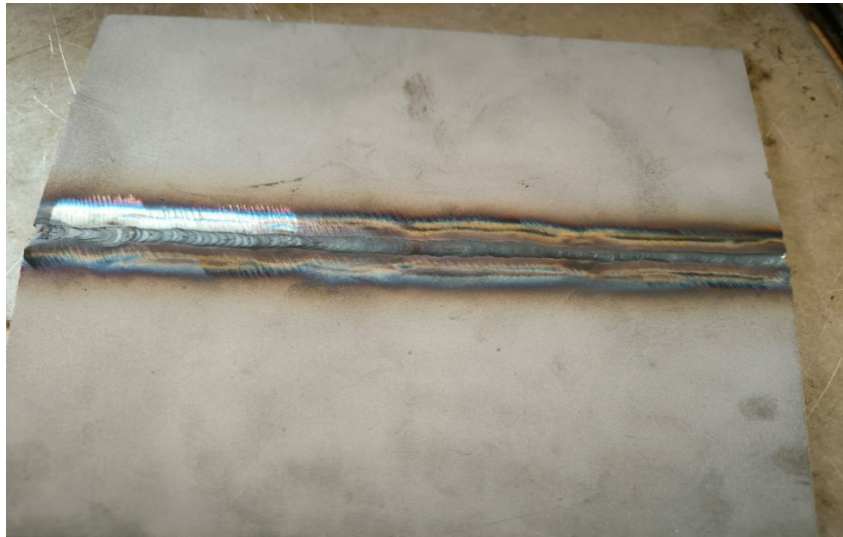
Slika 17. Prikaz zavarenih limova AISI 316L nehrđajućeg čelika Izvor: Autor
