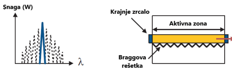
Slika 19. Emitirani spektar DFB lasera i shematski dijagram DFB lasera
