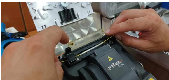
Slika 8. Priprema niti za postavljanje zaštite
