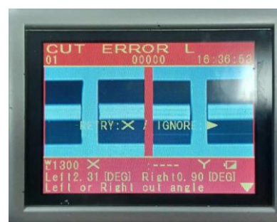
Slika 14. Greška radi loših rubova vlakana
