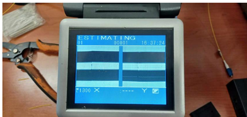
Slika 5. Zaslona splicera tijekom procjene kvalitete spoja između dvaju optičkih niti
