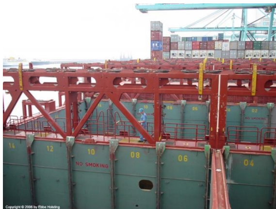
Slika 16.Primjer vodilica i palubnog mosta
