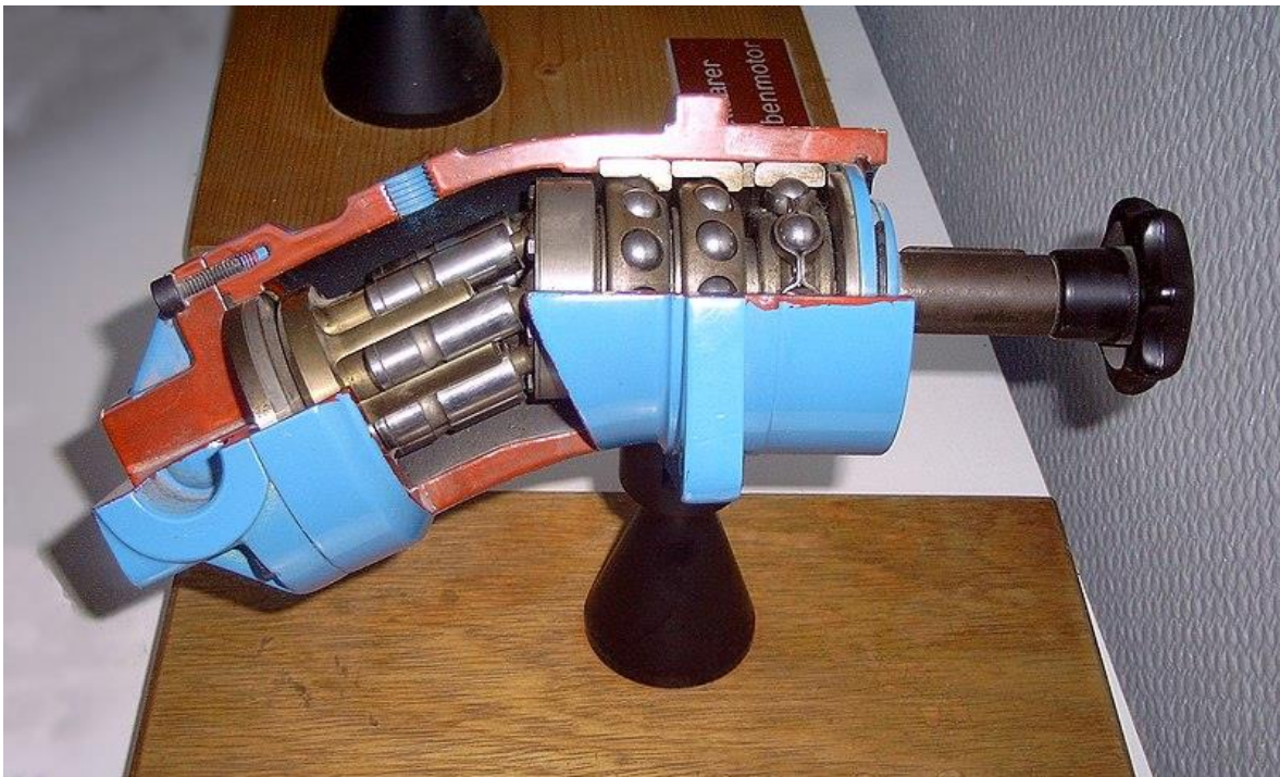
Slika 5. aksijalna klipna pumpa sa nagibnim rotorom
