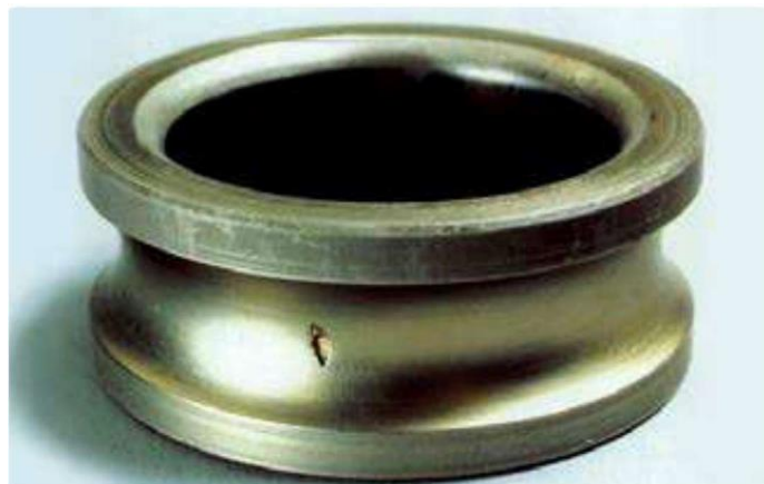
Slika 3. Pukotina u ležaju zbog zamora materijala [1]
