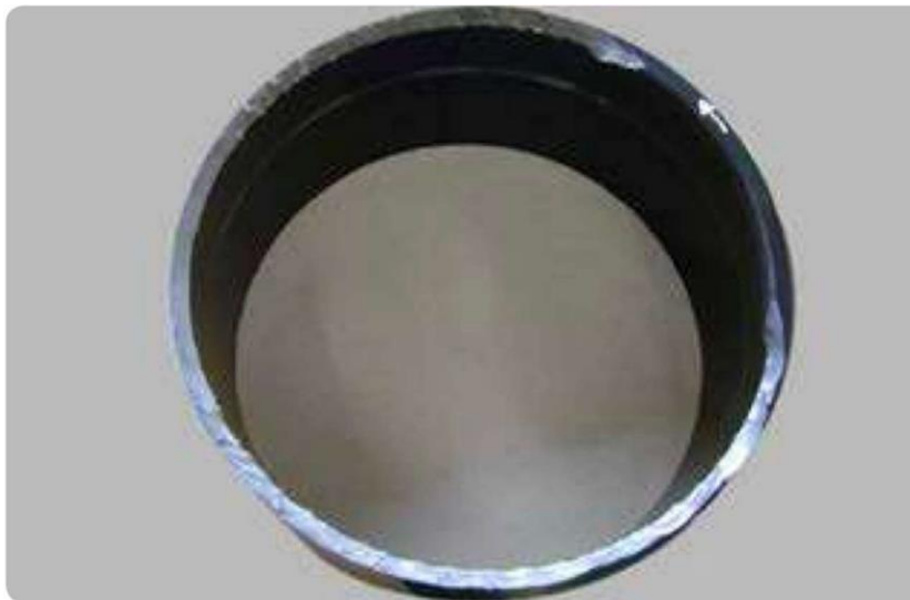
Slika 7. Oštećenje vanjskog prstena ležaja [1]
