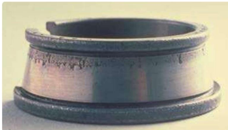
Slika 1. Oštećenje valjnog ležaja [1]
