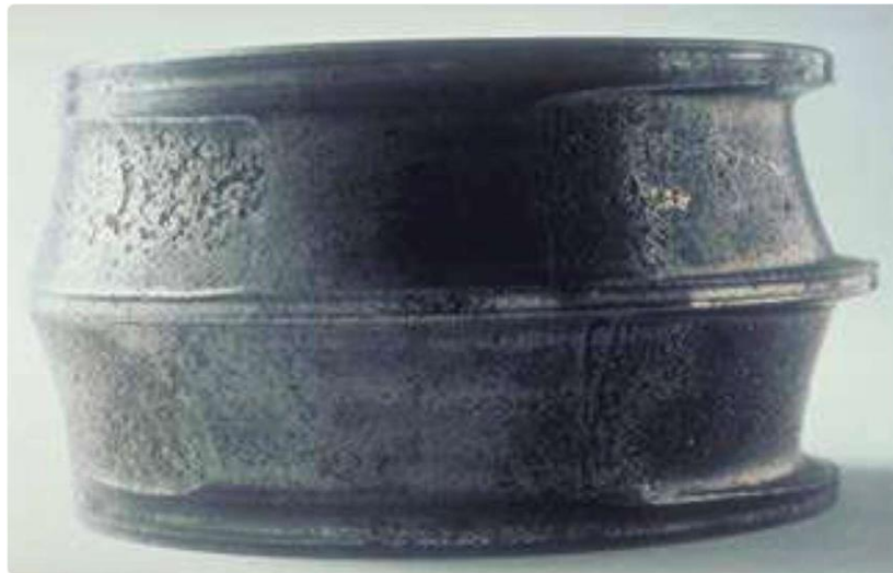
Slika 5. Istrošeni valjni ležaj(abrazija) [1]
