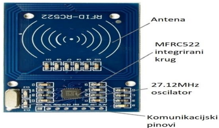
Slika 23. Dijelovi RFID Arduino čitača
