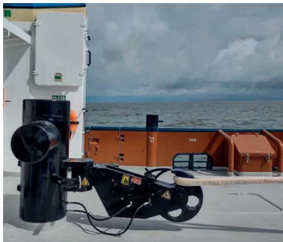
Slika 11. kuka za tegljenje kružne izvedbe pričvršćenu na bitvu
