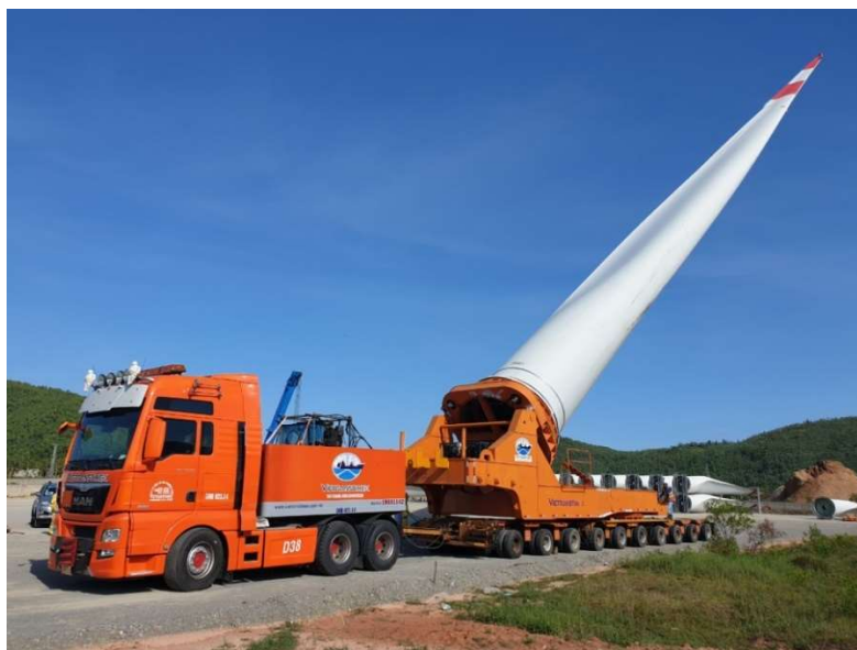
Slika 9. Adapter za prijevoz lopatica vjetroturbine
