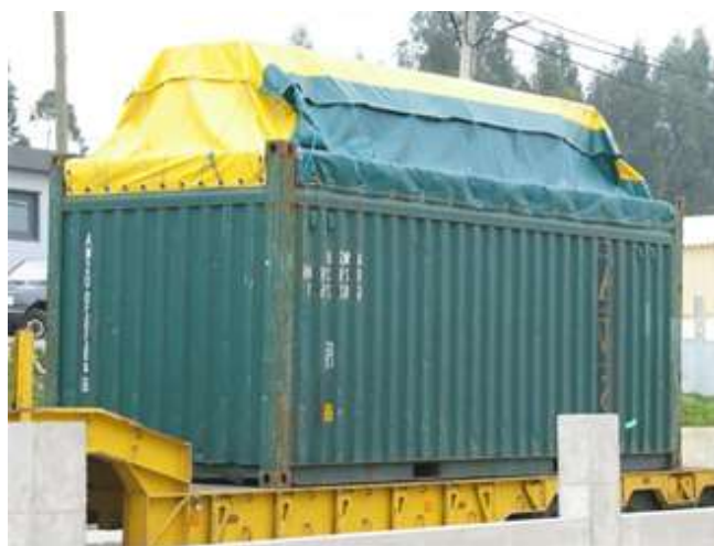
Slika 4. Prikaz „open top“ kontejnera koji je ukrcan na cestovno vozilo
