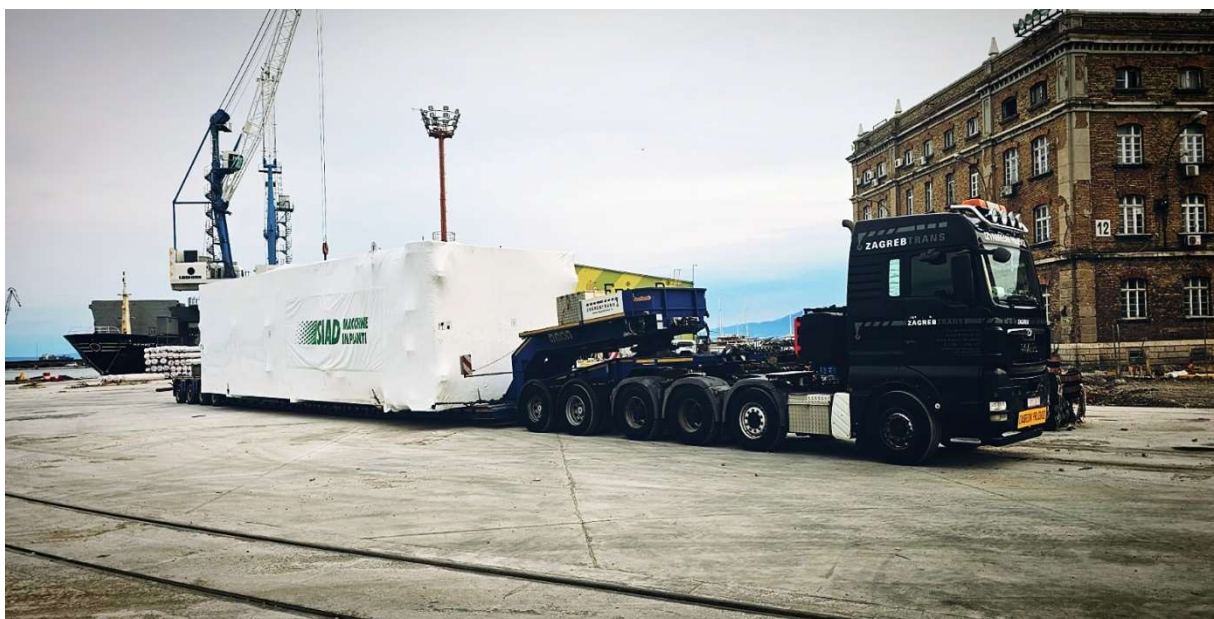
Slika 7. Transformator ukrcan na modularnoj kombiniranoj hidrauličnoj prikolici
