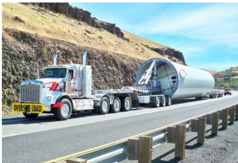
Slika 8. Toranj vjetroturbine ukrcan na specijaliziranu „schnabel“ prikolicu
