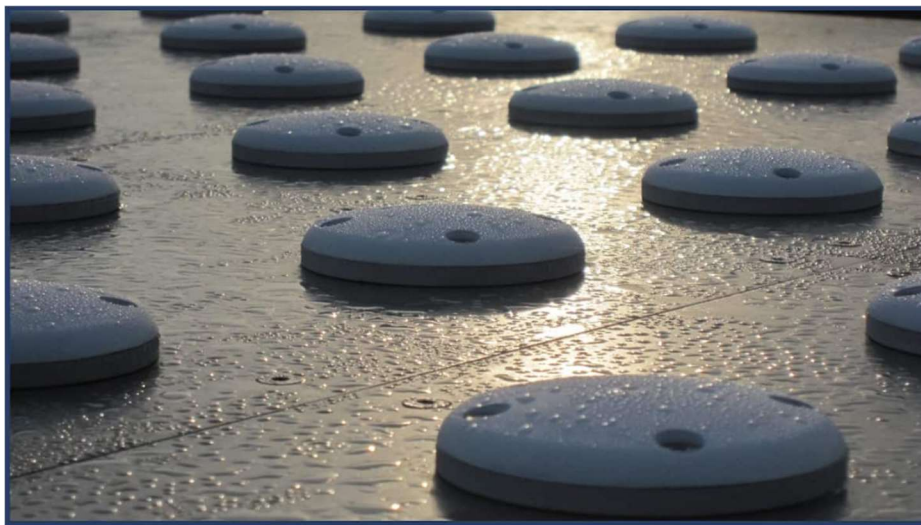
Slika 9: Uvećani prikaz površine ploče antenskog faznog niza [4]
