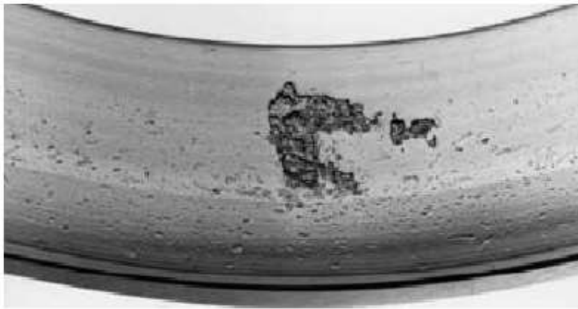
Slika 6. Oštećenje nastalo zamorom materijala na vanjskom prstenu ležaja [2]
