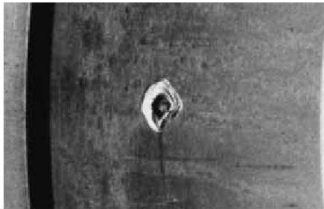
Slika 10. Oštećenje ležaja nastalo prolaskom struje [1]
