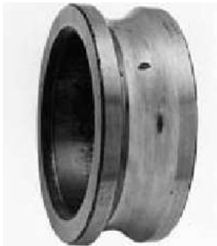
Slika 7. Oštećenje nastalo zamorom materijala na unutarnjem prstenu ležaja [2]
