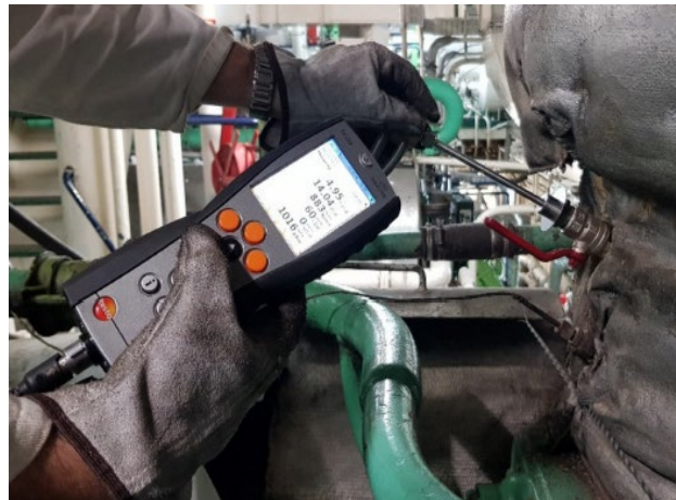
Slika 37. Prikaz mjerenja i priključka sonde
