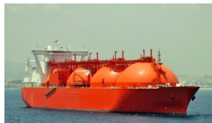
Slika: 2.2.2. Kvaerner-Moss sferični tip broda
