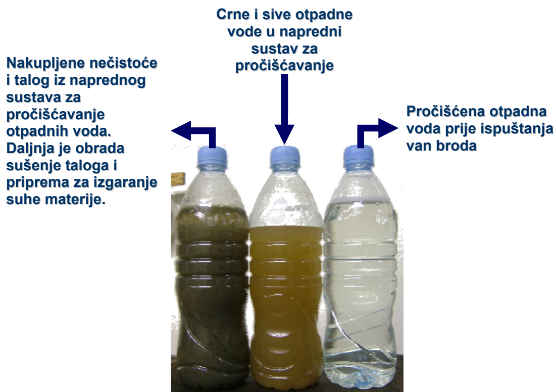
Slika 4.7. Uzorci vode na ulazu i izlazu iz naprednog sustava za pročišćavanje crnih otpadnih voda na brodovima za kružna putovanja.
