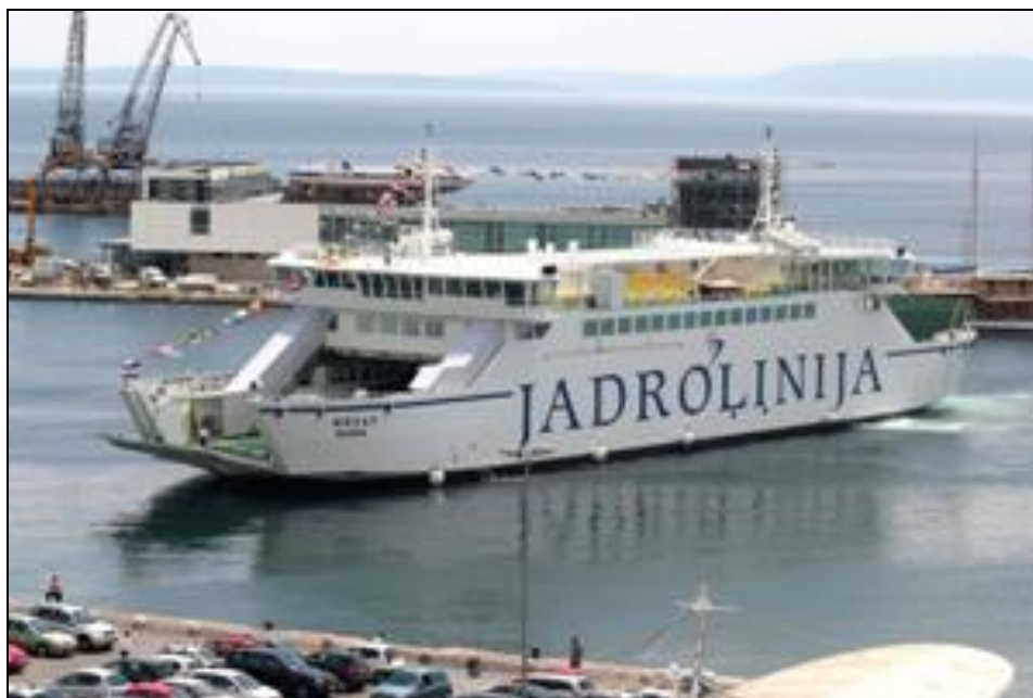
Slika 2. Ro-Ro putnički brod za srednje udaljenosti
