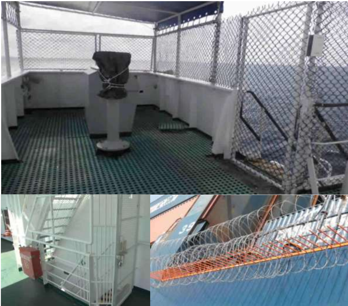
Slika 11. Fizičke prepreke u zaštiti pojedinih dijelova broda
