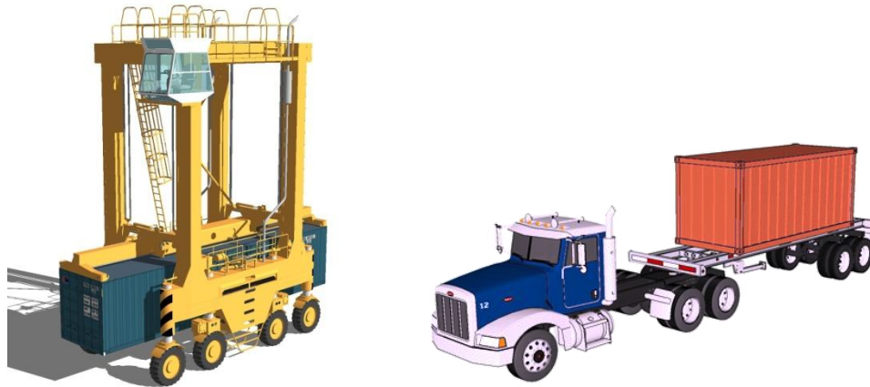
Slika 5: Prijevozno-prekrcajna sredstva: straddle carrier i tegljač s prikolicom.
