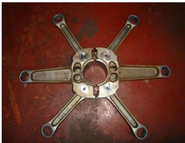
Slika 3.1 Sklop-klipnjača brzookretnog radijalnog dizelskog motora
