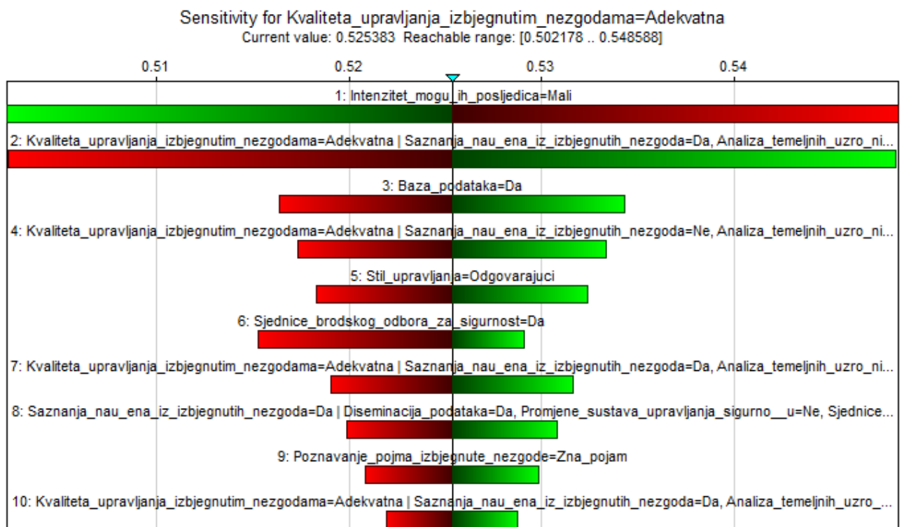
Slika 23. Tornado-dijagram za stanje „adekvatna“ čimbenika „kvaliteta upravljanja izbjegnutim nezgodama“ i 10 % promjene stanja ulaznih čimbenika
