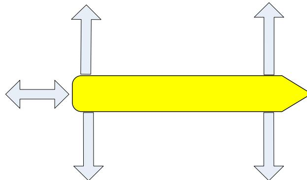
Slika 3. Kombinacija djelovanja azimutalnih propulzora i pramčanih potisnika
