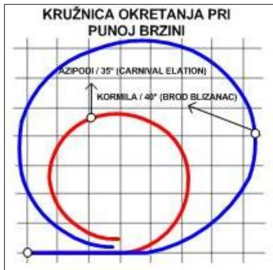
Slika 2. Usporedba kružnica okretanja dva broda blizanca pri punoj brzini (broda s dva vijka i dva lista kormila i broda s usmjerenom propulzijom)
