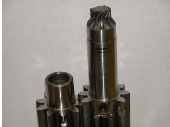
Slika 5.11. - Ekstremno oštećenje osovine i zubača zupčaste pumpe uslijed ulaza veće kontaminacije u prostor pumpe koja je uspjela zaglaviti zupčanike i samim time ih i devastirati
