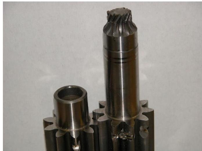
Slika 5.11. - Ekstremno oštećenje osovine i zubaca zupčaste pumpe uslijed ulaza veće kontaminacije u prostor pumpe koja je uspijela zaglaviti zupčanike i samim time ih i devastirati
