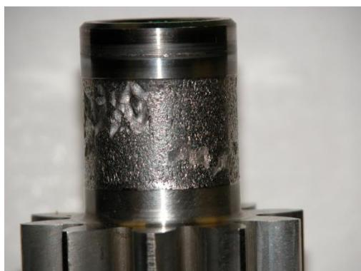
Slika 5.10 - Potpuno oštećenje ležaja
