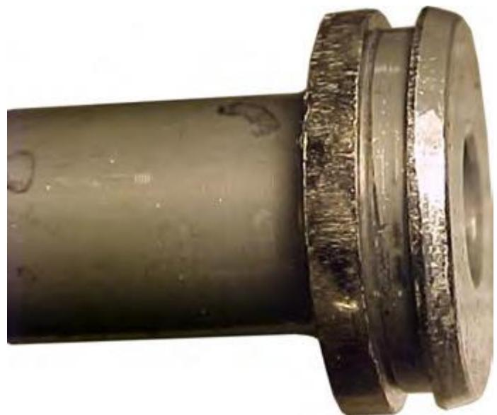
Slika 5.5 - Oštećenje stapa pumpe do te mjere da je došlo do puknuća stapnog prstena
