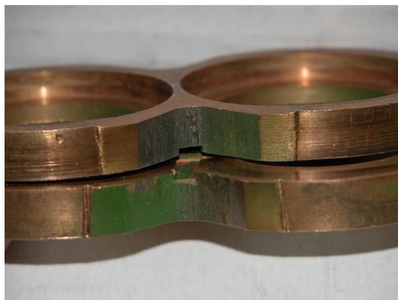
Slika 5.15. - Pumpa zategnuta van specifikacija koje izdaje proizvođač
