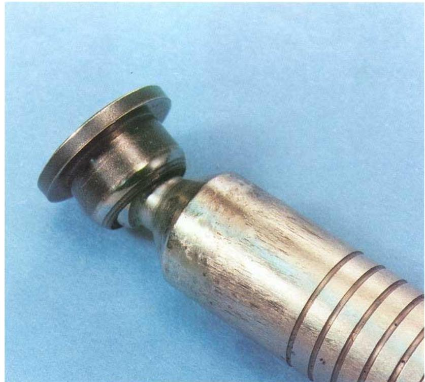
Slika 5.4. - Oštećenje klipa uslijed nedovoljnog ili gubitka podmazivanja
