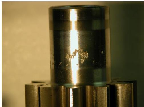
Slika 5.9. - Početak oštećenja ležaja zupčaste pumpe
