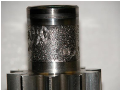
Slika 5.10 - Potpuno oštećenje ležaja
