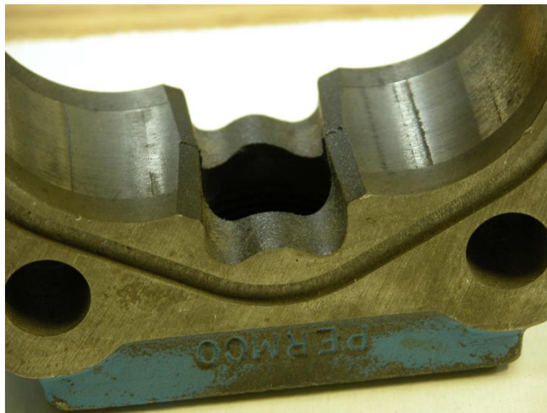
Slika 5.12. - Primjer postojanja manje kontaminacije u pumpi
