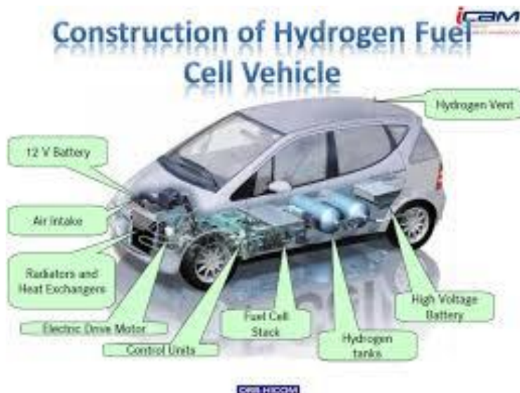
Slika 5.3. Dijelovi vozila koji koristi vodik
