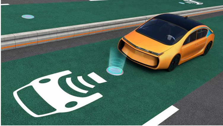
Slika 3.7. Primjer postavljanja bežičnog punjenja BEV
