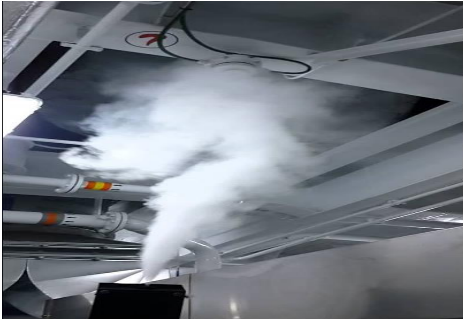
Slika 3: Testiranje senzora za dim
