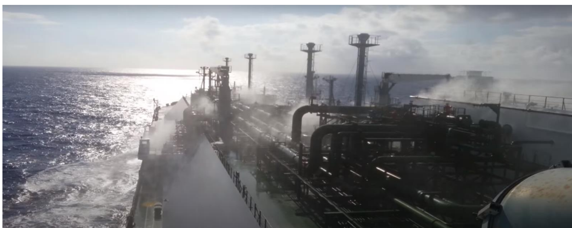
Slika 9: Testiranje sustava za raspršivanje vode po palubi
