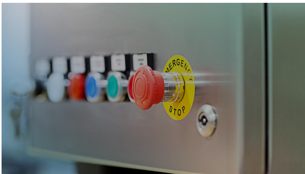
Slika 2: Prikaz ESD ručnog gumba
