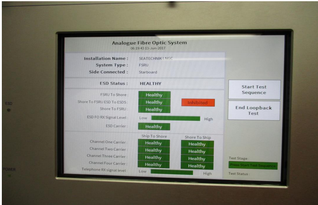
Slika 24: testiranje ESD sustava na FSRU Hoegh Giant Izvor: privatna arhiva capt. Matthew Sumner
