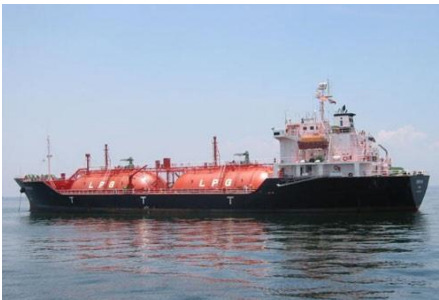
Slika 10. Brod za prijevoz ukapljenog naftnog plina (tankovi tipa C)
