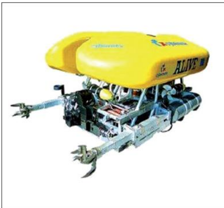
Slika 7. Lebdeća AUV ronilica (Izvor: www.perronerobotics.se/Images/Alive1.jpg )
