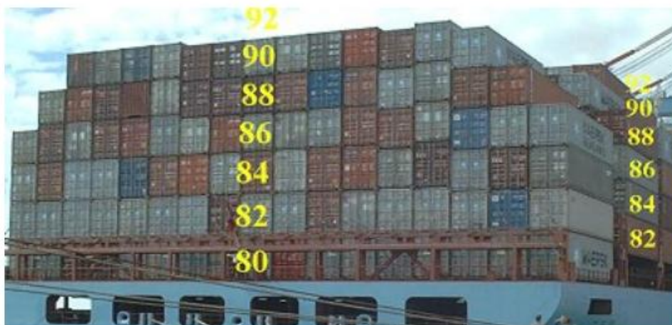
Slika 14: Numeriranje horizontalnih slojeva kontejnera
