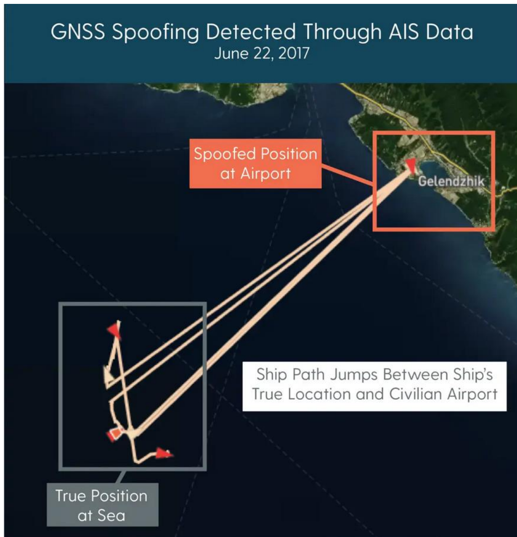
Slika 8. Ranjivost GNSS sustava
