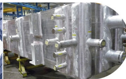
Mid-scale LNG plant - Air Liquide Brazed Aluminium PFHE
