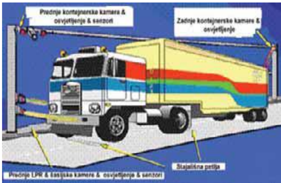
Slika 8. Prikaz komponenata sustava SeaGate
