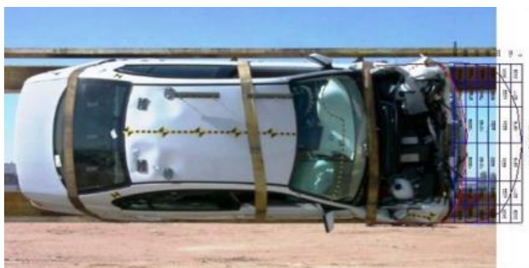
Slika 22 prikaz deformacija na vozilu
