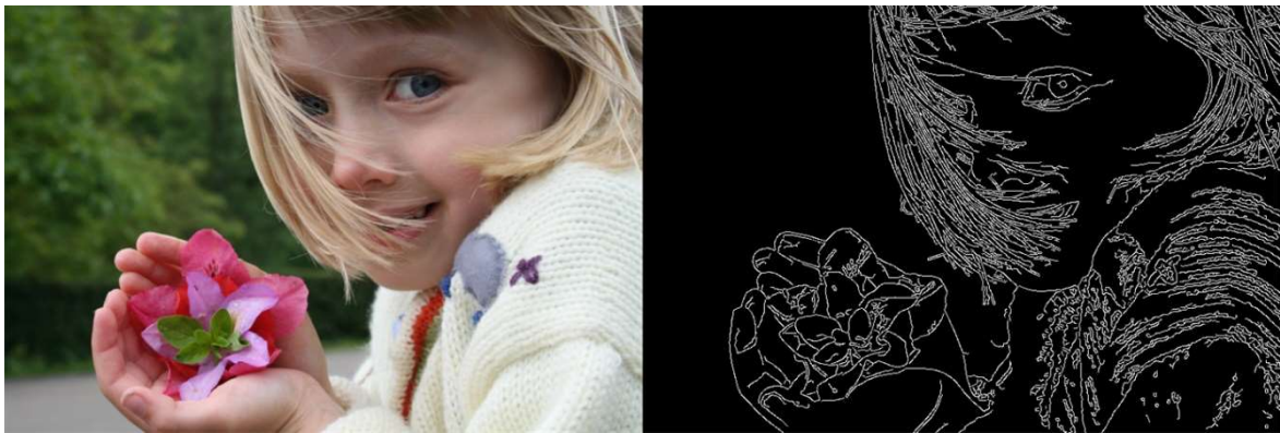
Slika 3 Detekcija ruba prikazana na slici pomaže umjetnoj inteligenciji sastaviti informativne apstraktne strukture iz neobrađenih podataka
