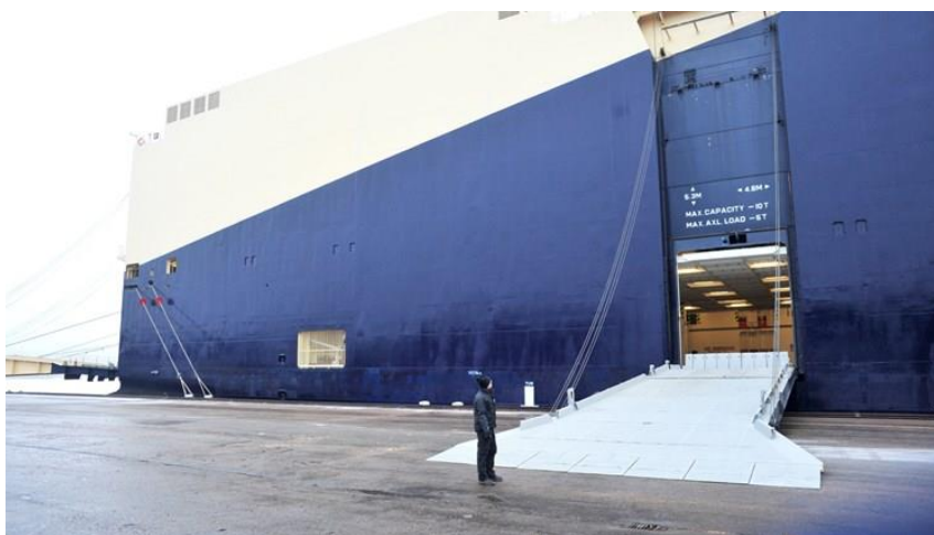
Slika 7 Rampa/Vrata na boku broda
