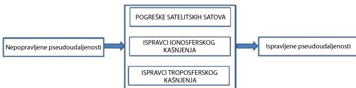
Slika 11. Model popravka izvornih (nepopravljenih) izmjerenih GNSS pseudoudaljenosti u navigacijskoj domeni GNSS prijammnika za satelitsku navigaciju
