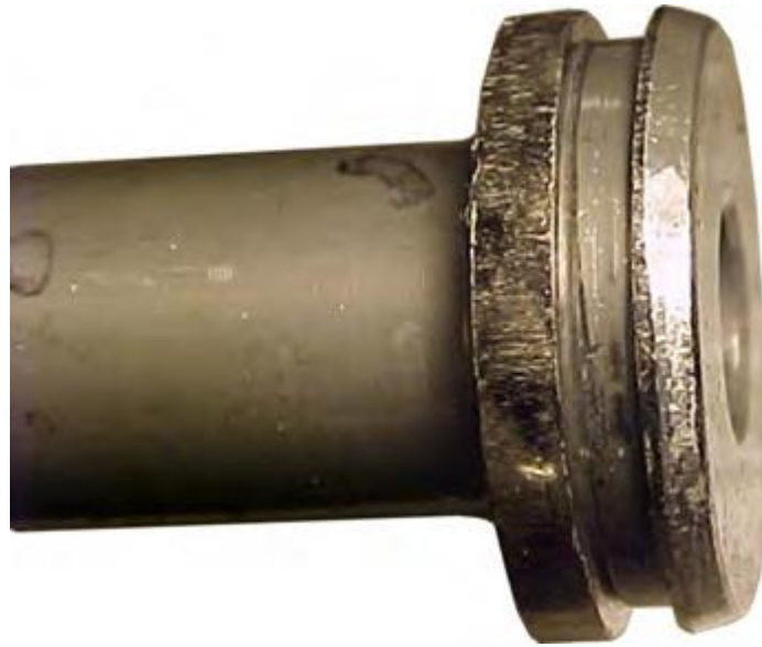
Slika 5.5 - Oštećenje stapa pumpe do te mjere da je došlo do puknuća stapnog prstena
