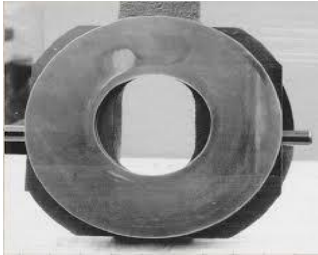
Slika 5.8. - Redosljed oštećenja nagibne ploče uslijed uzdizanja klipa. Na donjoj strani se vidi početak uzdizanja klipa, a u nastavku krajnji ishod kada se sedlo klipa u potpunosti odvoji
