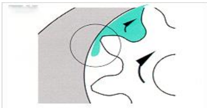
Slika 4.6 - Prikaz klasičnog hidrauličnog gubitka kod zupčaste pumpe
