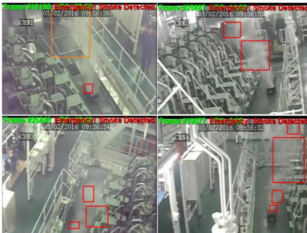
Slika 71: Videodetekcija dima pomoću 4 kamere u razmaku od 3 sekunde
