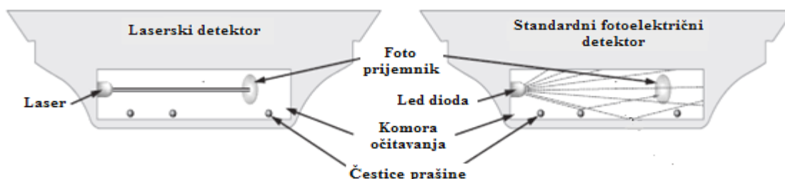
Slika 12: Usporedbe standardnog fotoelektričnog detektora dima i laserskog detektora dima
