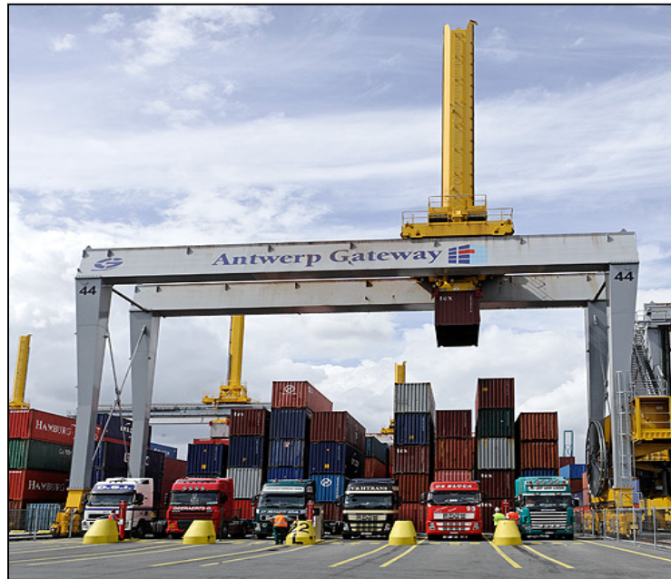
Slika 16 Tipična ASC dizalica(RMG tipa) na kontejnerskom terminalu Antwerpen
