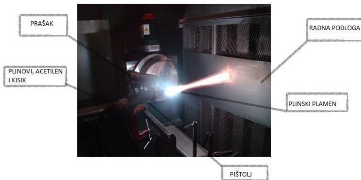
Slika 13. Plinsko naštrecavanje praškom
