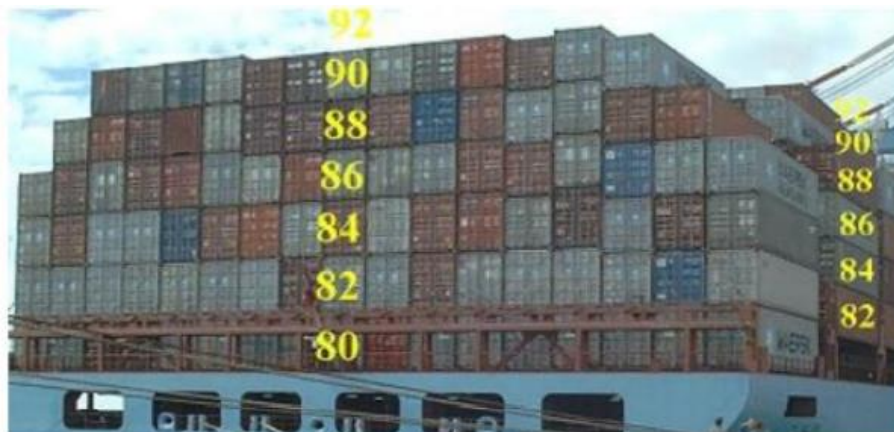
Slika 7. Pozicioniranje kontejnera u visinu
