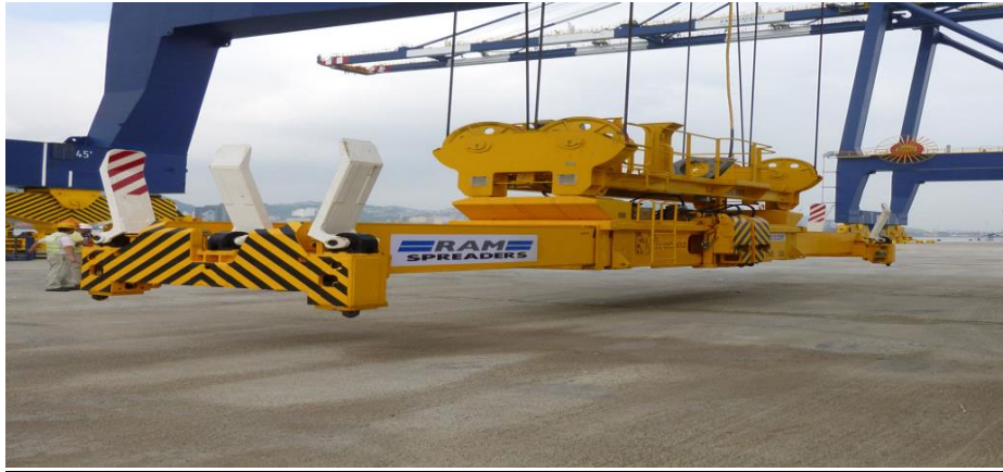
Slika 8. Hvatač kontejnera (spreader)
