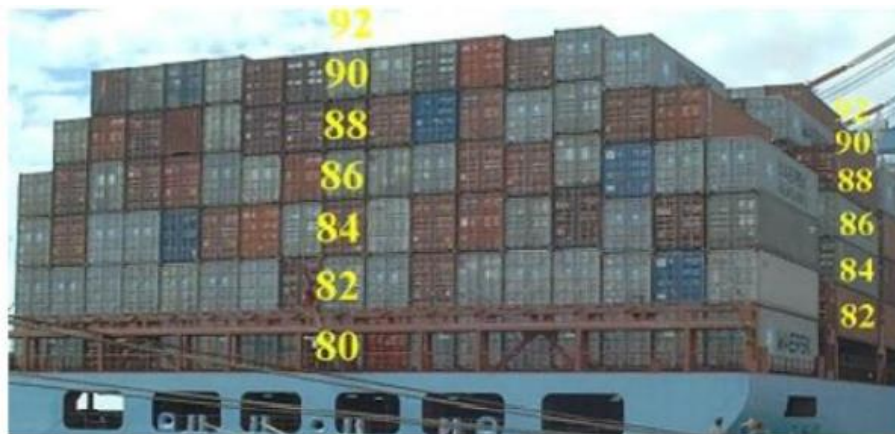
Slika 7. Pozicioniranje kontejnera u visinu
