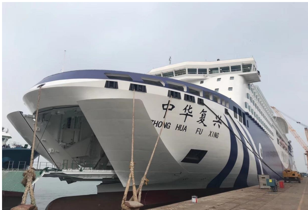
Slika 2.:Pramčana aksijalna rampa
