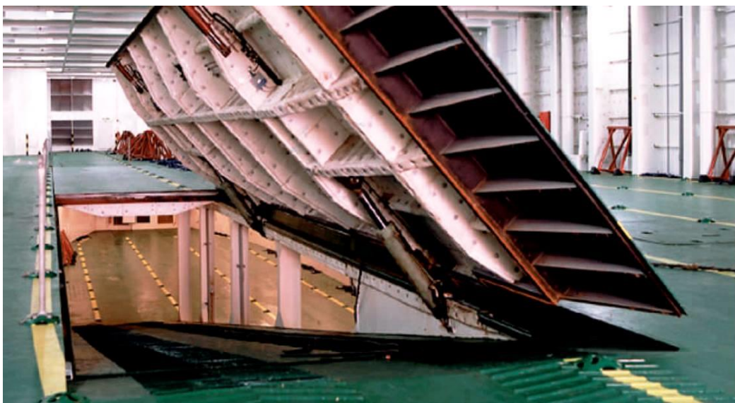
Slika 6.: Otvor kose rampe
