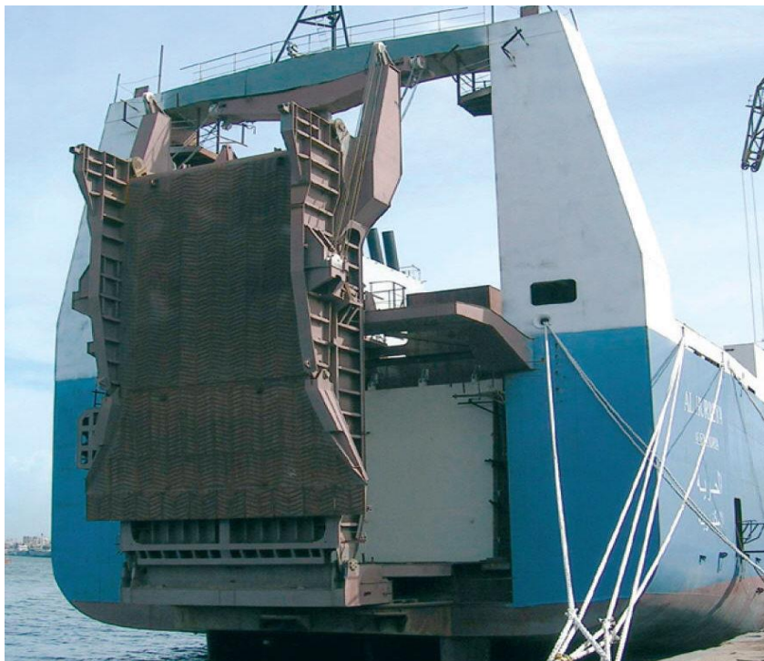
Slika 4.: Krmena okretna rampa
